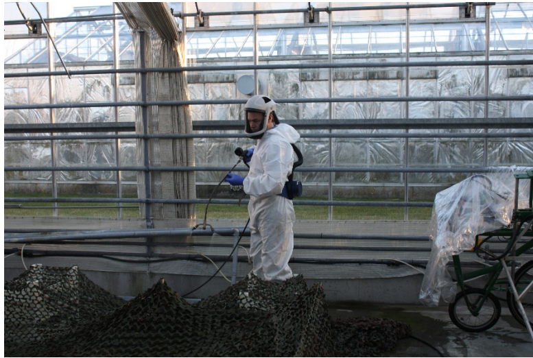
Billede 7. Lancesprøjtning med meget grov forstøvning (ASJ HCA 8003 dyse).
