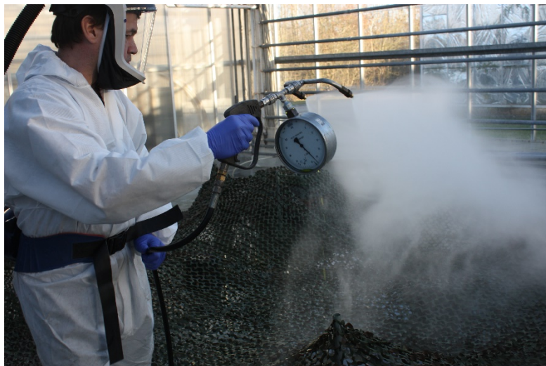
Billede 6. Lancesprøjtning med meget fin forstøvning (TN18 dyse).
