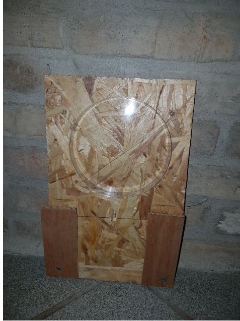
Billede 3. Træplade med underskål fra petriskål monteret med fin tråd. Tråden kan fjernes uden at berøre underskålens inderside, når denne skal afmonteres efter nedtagning. På billedet er træpladen nedsat i holderen.
