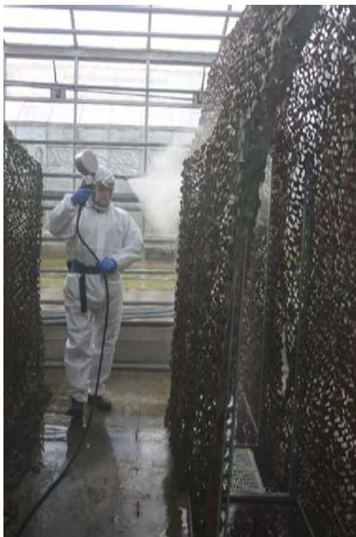
Billede 7. Lancesprøjtning med meget fin forstøvning (TN18 dyse.)
