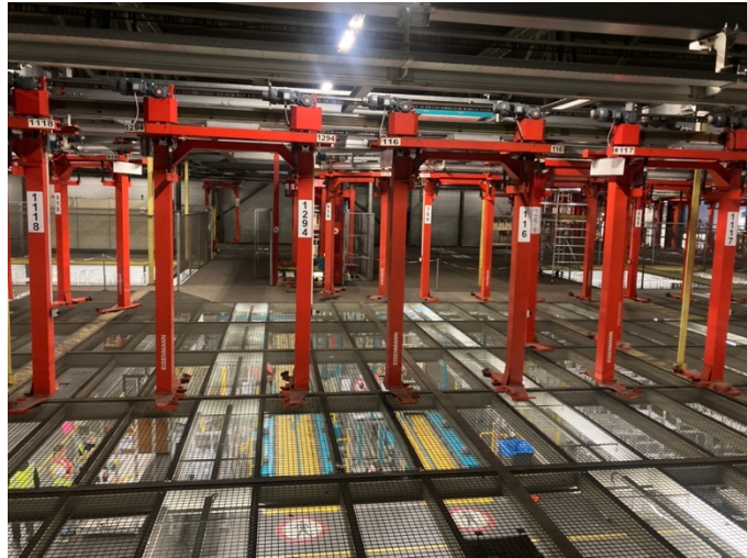
Billede 4 Disse robotter løfter vognene og flytter dem mellem afdelinger, udenfor over en bro på vejen. Derefter havner de i pakke/fragt centralen og sat i lastbiler.
